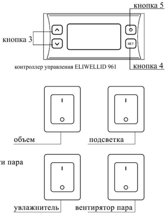
Во время нормальной работы дисплей показывает текущую температуру рабочего пространства охлаждаемой витрины. В случае какого-либо сбоя экран полностью погаснет, либо индицируется ошибка с префиксом «E». (Рисунок 1 и 2).
